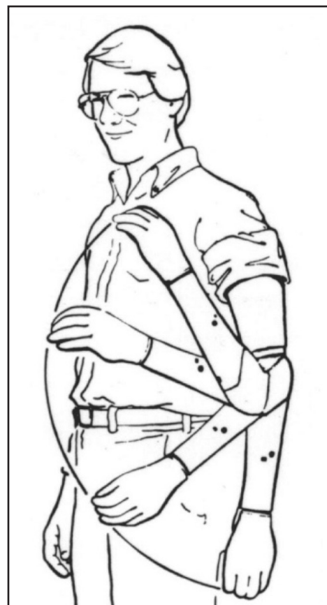
Bild 7 – Myoelektrisk armbågsstyrning, kontrahera din "upp"-muskel för att höja. Slappna av båda musklerna för att sänka och aktivera "Tyst fripendel"
