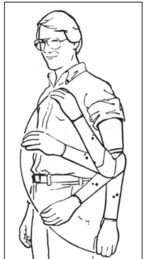
Afbeelding 7 – Myo-elektrische elleboogbesturing; span uw biceps aan om uw onderarm op te tillen. Ontspan beide spieren om de onderarm te laten zakken met 'stille vrijzwaai'.
