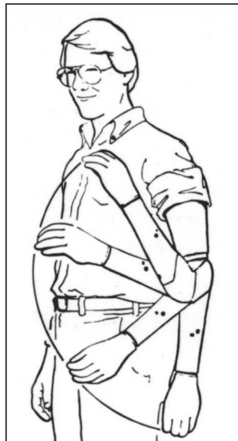
Figura 7 – Controllo mioelettrico del gomito; contrarre il muscolo "verso l'alto" per sollevare. Rilassare entrambi i muscoli per abbassarli con la funzione "Silent Freeswing"
