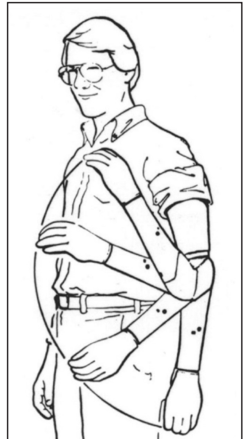
Figura 7 - Control mioeléctrico del codo; contraiga el músculo hacia "arriba" para levantar. Relaje ambos músculos para bajar con "oscilación libre".
