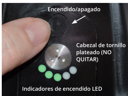
El botón de encendido y los indicadores luminosos LED rojas/verdes se encuentran en la parte delantera del codo.
