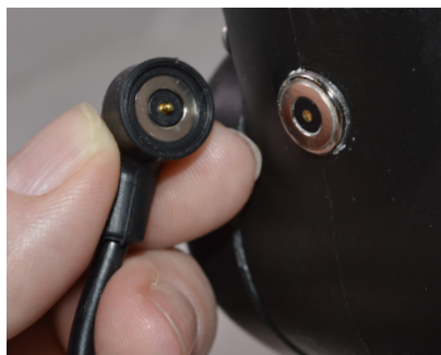
El puerto de carga se encuentra en la parte posterior del codo y se conecta con un enchufe de carga magnético desprendible.
