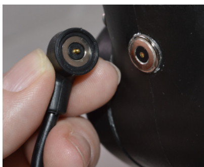
Laddningsporten är placerad på baksidan av armbågen och ansluts med en magnetisk laddningsplugg.
