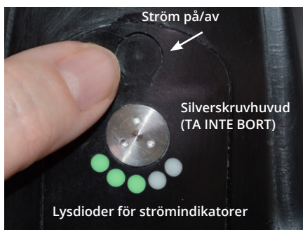
Strömbrytaren och de röda/gröna LED-indikatorlamporna är placerade på framsidan av armbågen.
