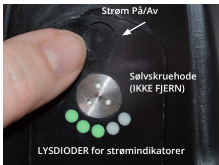
Strømknappen og røde/grønne lysdioder er plassert på forsiden av albuen.
