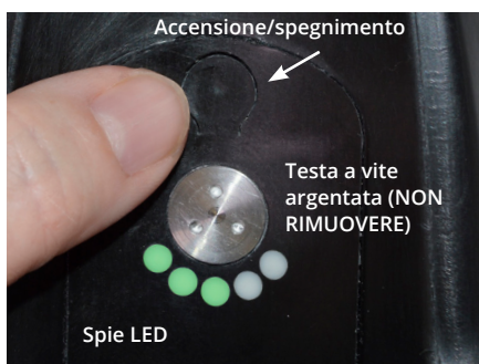
Il pulsante di accensione e le spie LED rosse/verdi si trovano sulla parte anteriore del gomito.
