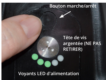
Le bouton d'alimentation et les témoins LED rouge/vert se trouvent à l'avant du coude.
