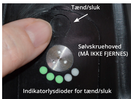
Tænd/sluk-knappen og de røde/grønne indikatorlysdioder er placeret på forsiden af albuen.
