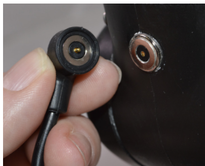
De laadpoort bevindt zich aan de achterkant van de elleboog en maakt verbinding met een losbreekbare magnetische laadstekker.
