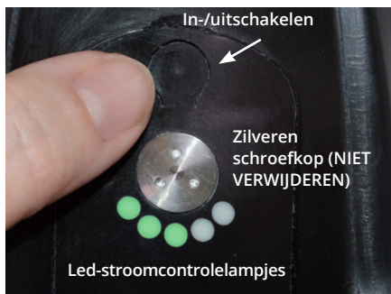
De aan/uit-knop en rood/groene led-controlelampjes bevinden zich aan de voorkant van de elleboog.
