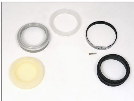
Montaggio del collare di laminazione
