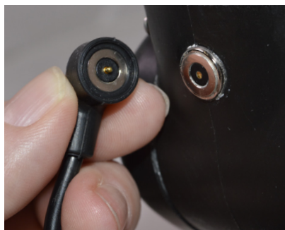
Le port de charge est situé à l'arrière du coude et se connecte à une fiche de charge magnétique détachable.
