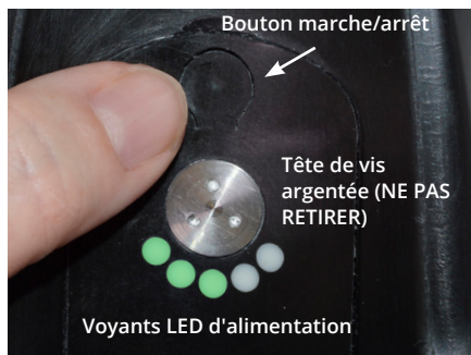
Le bouton d'alimentation et les témoins LED rouge/vert se trouvent à l'avant du coude.
