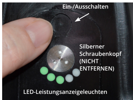
Der Netzschalter und die rot/grüne LED-Anzeige befinden sich auf der Vorderseite des Ellenbogens.
