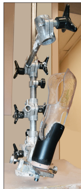
Bild 4 – Vertikal överföringsfixtur med tillfällig inriktningsfixtur tillverkad i PVC.
