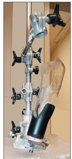
Figur 4 - Vertikal overføringsfeste med midlertidig innrettingsfeste tilvirket av PVC.
