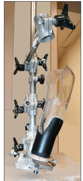
Afbeelding 4 - Verticale transfervoorziening met tijdelijke uitlijnvoorziening van PVC.
