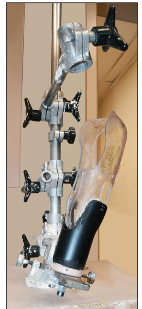
Figure 4 - Appareil de fixation pour transfert vertical avec dispositif d'alignement temporaire fabriqué en PVC.
