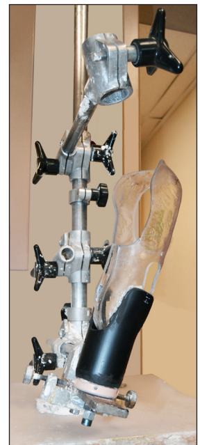
Kuva 4 – Pystysuora siirtolaite, jossa on tilapäinen PVC-putkesta valmistettu kohdistusesine.
