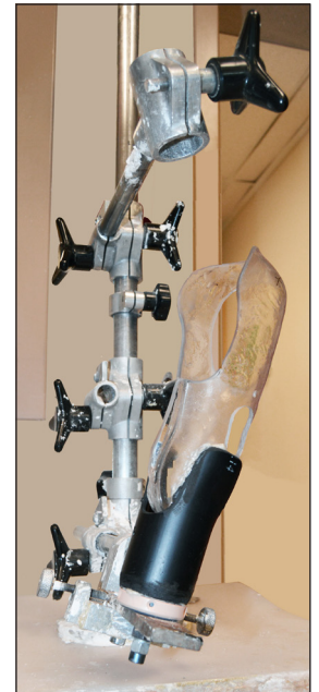
Figura 4 - Accesorio de transferencia vertical con fijación con alineación temporal fabricada en PVC
