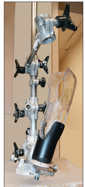
Abbildung 4 - Vertikale Transfervorrichtung mit provisorischer Ausrichtvorrichtung aus PVC.
