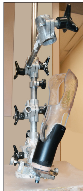
Dispositivo di trasferimento verticale con dispositivo di allineamento temporaneo in PVC.
