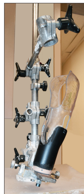
Afbeelding 5 Verticale transfer- voorziening met tijdelijke uitlijnvoorziening van PVC.
